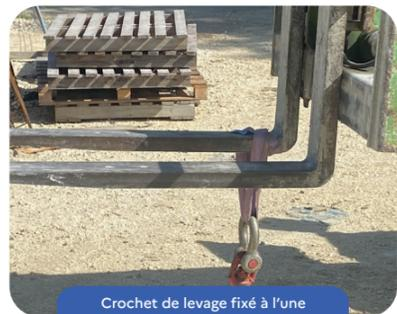
Crochet de levage fixé à l'une des fourches du chariot élévateur
