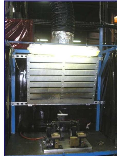
Vitesse d'aspiration recommandée au point d'émission > 0,5 m/s
