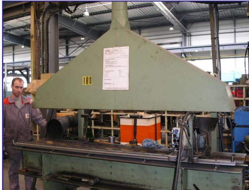
**L'opérateur ne doit pas être sur le trajet ascendant des fumées.**
