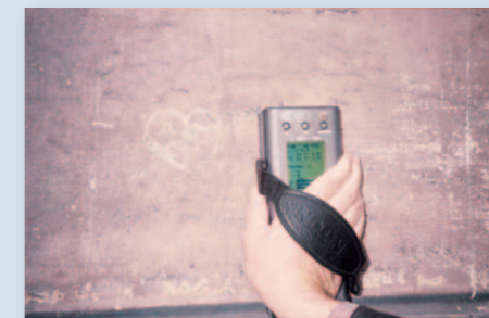
Le diagnostic plomb s'impose pour les immeubles antérieurs à 1949 ; il est fortement conseillé en cas de doute pour les constructions postérieures à cette date.
