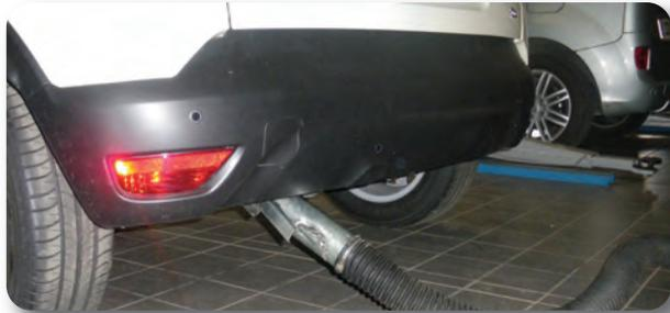
En utilisant un filtre mobile uniquement pour les transferts de véhicules dans l'atelier ou dans les halls d'exposition.
