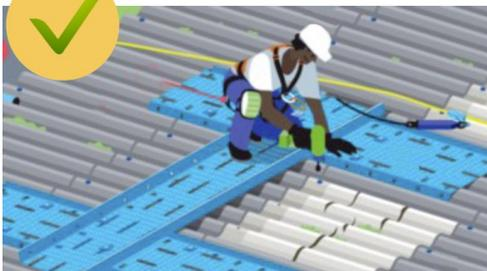
En cas d'impossibilité technique de recourir aux protections collectives, des **équipements individuels antichute seront utilisés** (équipements composés d'un harnais, d'un dispositif antichute avec absorbeur d'énergie et d'un point d'ancrage). **L'usage de ces équipements implique la formation des utilisateurs, l'élaboration par l'employeur d'une notice précisant** les points d'ancrage, les dispositifs d'amarrage et les modalités d'utilisation. de l'équipement de protection individuelle.
