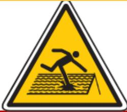
Les **toitures** fragiles sont souvent la cause de chutes de hauteur. Leur composition en **matériaux fragiles** (matériaux opaques, plaques de fibrociment, amiantées ou non, tôles rouillées, charpentes vétustes...) ou en **matériaux translucides** ne garantit pas leur résistance
